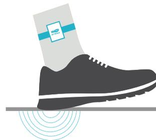
BitWalk misura il carico esercitato al suolo. Attraverso i valori di pressione è in grado di identificare le principali fasi del passo dell'utente e ricavare i parametri cinematici/dinamici.
